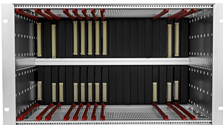
Рис. 3 – Фотография корзины управляющего блока CU7210 (ведущий) без модулей и передних заглушек, вид спереди
